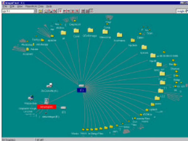
Bild 8. Hyperbolic Tree 1 – Visualisierung des Dateibaums einer Festplatte. Durch die einfache Bewegung der Maus wird der Dateibaum wie auf einer Kugeloberfläche entfaltet. Der hyperbolic Tree ermöglicht einen guten Überblick und einen schnellen Zugriff auf einzelne Verzeichnisse und Dateien des Verzeichnibaumes.
